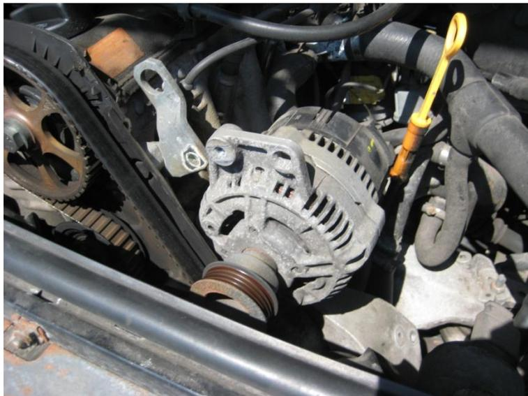
Danach kann der Keilrippenriemen entfernt werden. Nun ist der Halter der Servopumpe gut zugänglich unter dem die Wasserpumpe verbaut ist. Also demontieren wir im nächsten Schritt die
