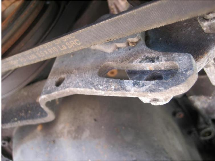
Im Anschluss daran können die Schrauben an der Ölwanne und an der Oberseite des Halters entfernt werden. Letztere gehen durch das Pumpengehäuse der Wasserpumpe und halten diese somit auch.
